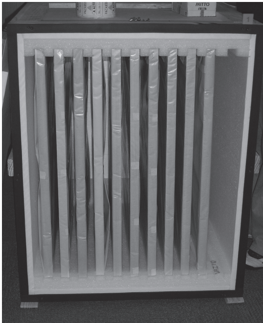
Figura 6 - Caixa-trilho para embalagem de obra de arte, destinada a acolher conjunto de quadros com a mesma dimensão.
